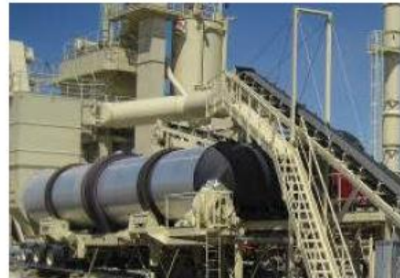
Foto 6. Tambor calentador de flujo paralelo, específico para MRMB
